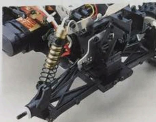
ダブルウィッシュボーン・リアサスペンションに、プレッシャーダンパーを装備。抜群の路面追従性を発揮。
