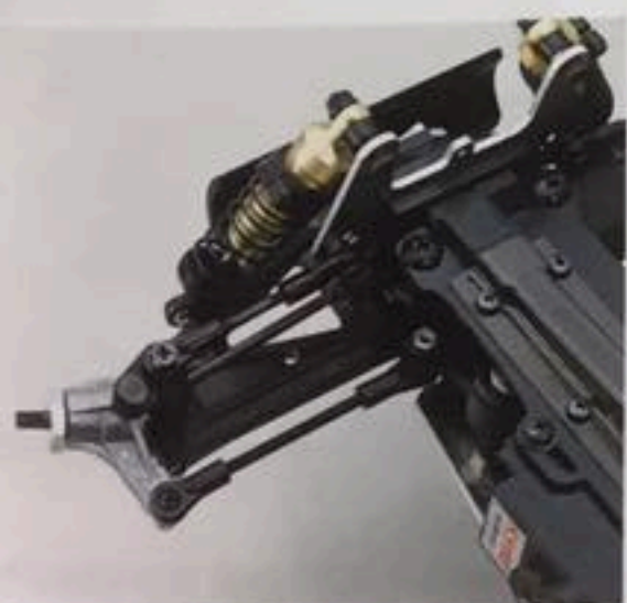
数々のレース経験から生まれた、ロングストロークのダブルウィッシュボーン・フロントサスペンション。
